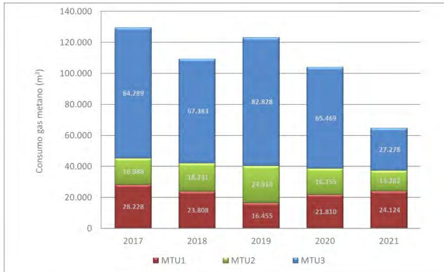
Figura 10: Consumo gas metano per riscaldamento e acqua calda diviso per stabilimento produttivo
